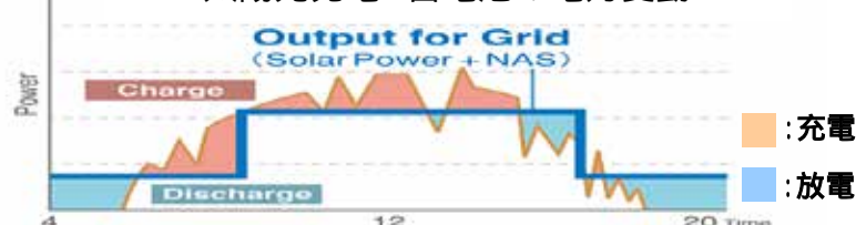
太陽光発電+蓄電池の電力変動
